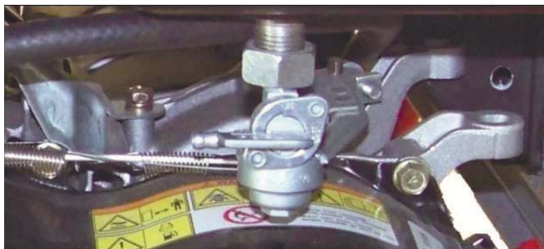
Рис. 4.6: Закрытие топливного клапана
