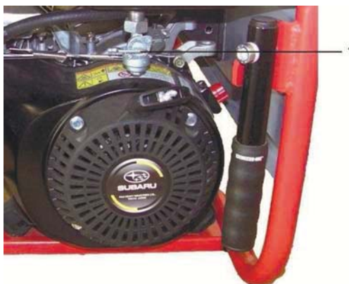
Рис. 4.1: Открыть/закрыть топливный кран
