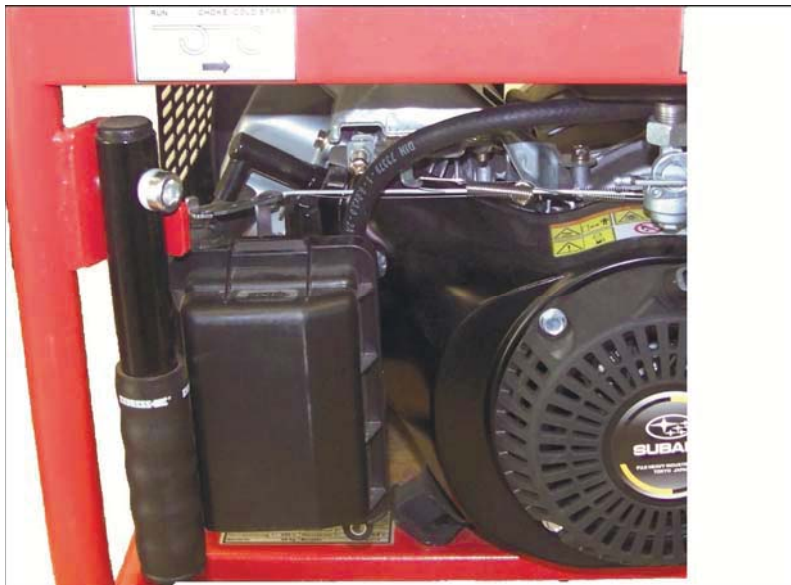
Рис. 4.8: Снятие воздушного фильтра
