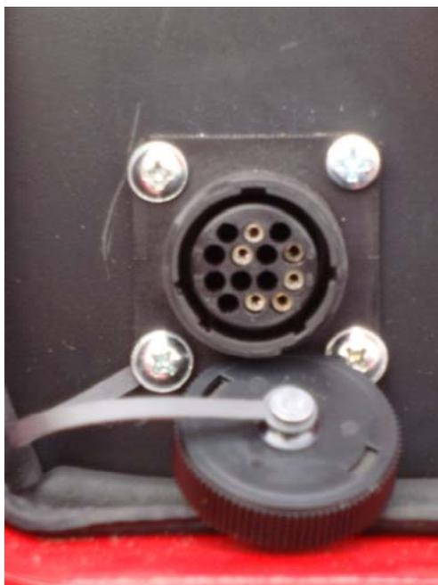
Изобр. 1 Разъём с защитной крышки
