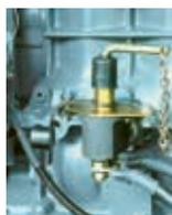
Главный выключатель аккумуляторной батареи отсоединяет аккумуляторную батарею от всех компонентов электрогенератора.
