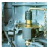
Главный выключатель аккумулятора отсоединяет аккумуляторную батарею от всех компонентов электрогенератора.
