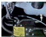
3-ходовой топливный кран для непосредственного подключения наружного топливного бака.
