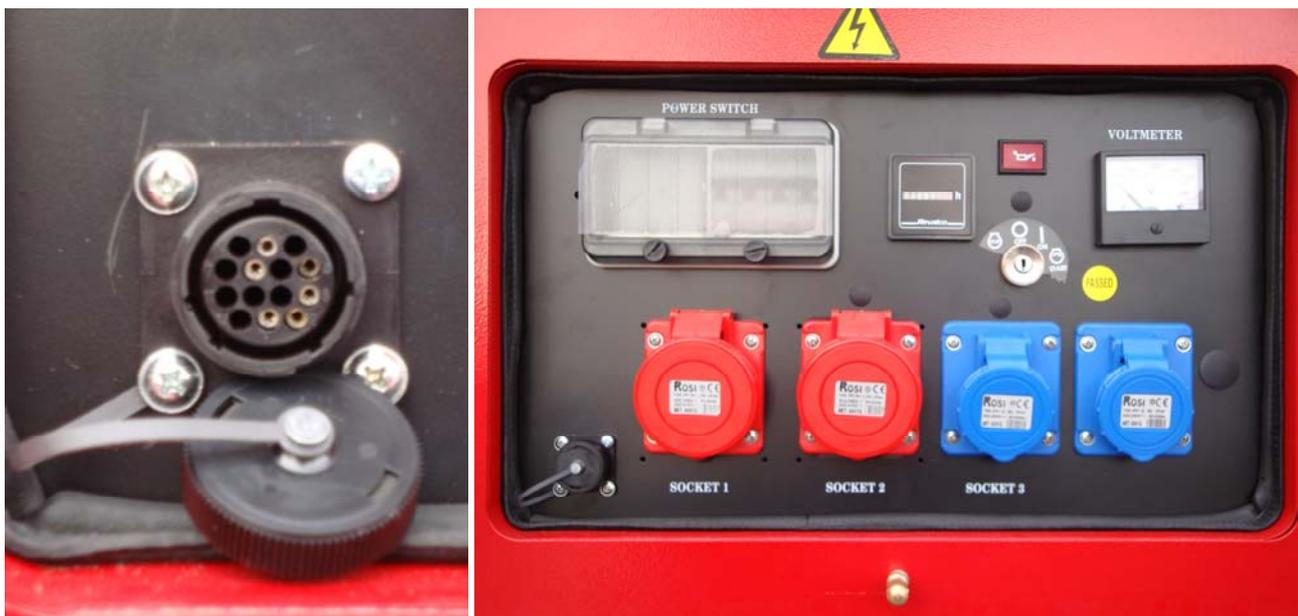
Изобр. 1 Разъём с защитной крышки у модели ESE 1204 DHS ES Diesel
