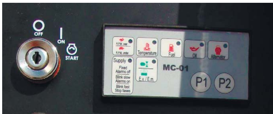
Рис. 13 - Ключ ручного запуска и панель контроля мотора
